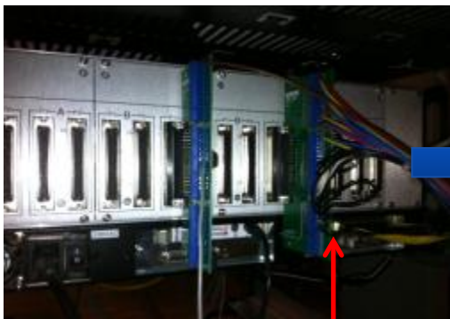
Analog Outputs from IO to Megger SMRT1
